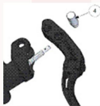
1. Coloque la bomba de manera que se pueda extraer fácilmente el pasador elástico de 1,5 mm de diámetro (1) con un destornillador de pasador adecuado.
